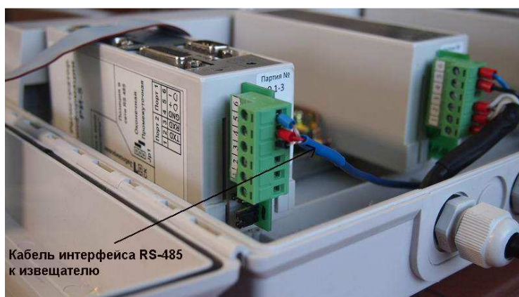
Подключение кабеля интерфейса RS485 на клеммы-разъемы регистратора, корпус БИП открыт.
